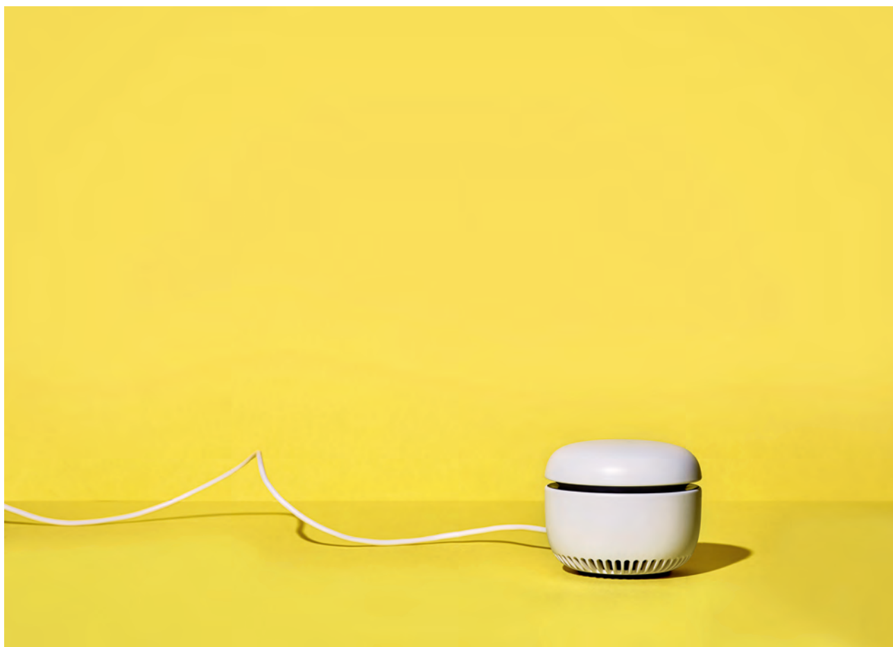
So sieht der Smart Sensor aus, der beim «Design Preis Schweiz 2019/20» in der Kategorie «Product – Consumer Goods» gewinnt: Der Sensor «Caru» sammelt Daten über Temperatur, Geräuschpegel, Luftqualität und -feuchtigkeit.
